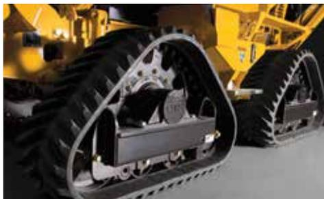
**VENTAJA DE ORUGAS CUÁDRUPLES.** El sistema de orugas cuádruples opcional ofrece un menor daño a la superficie y un aumento del esfuerzo de tracción.
