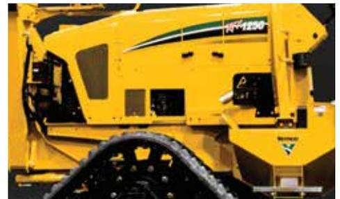
**MAYOR POTENCIA.** Cuando el motor de la RTX1250 cae de las 2500 rpm a 2300 rpm con carga, la potencia aumenta de 89 kW (120 hp) a 93 kW (125 hp), lo que permite que la RTX1250 funcione a máxima potencia en modo de trabajo.
