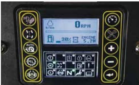
**CONOCIMIENTO EN PANTALLA.** Una pantalla integrada permite que el operador optimice el rendimiento de la máquina mediante el ajuste de los accesorios en funcionamiento y los parámetros del sistema de desplazamiento, mientras que proporciona información de diagnóstico, como rpm del motor, nivel de combustible, voltaje de la batería, temperatura del refrigerante del motor y horas del motor.
